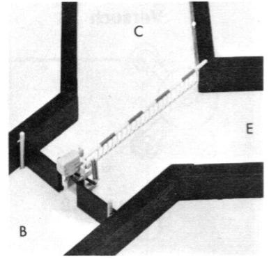
die „Schranke“ durch eine andere Kraft angehoben wird, kann kein Strom von E nach C (Abb. 64) oder umgekehrt (Abb. 65) durch den Transistor hindurchfließen.
