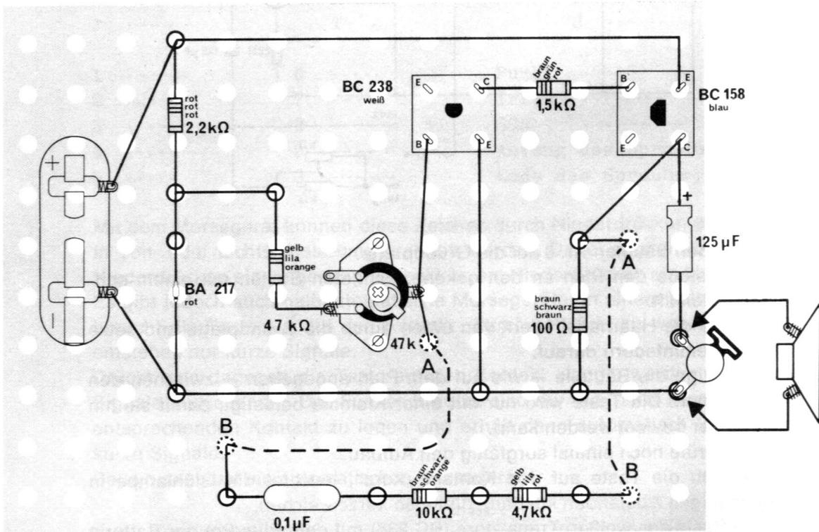
**Abb. 113** Zwischen den Löchern A und B muß du den blanken Draht unter der Grundplatte durchziehen.
