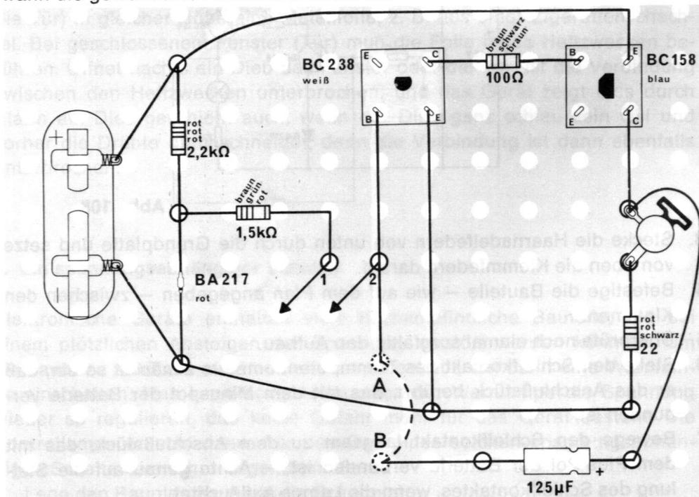
**Abb. 109** Zwischen den Löchern A und B muß du den blanken Draht unter der Grundplatte durchziehen.
