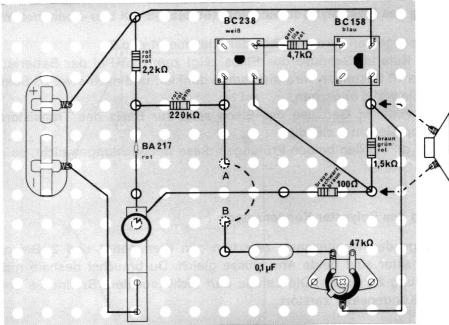
Zwischen den Löchern A und B muß du den blanken Draht unter der Grundplatte durchziehen.
