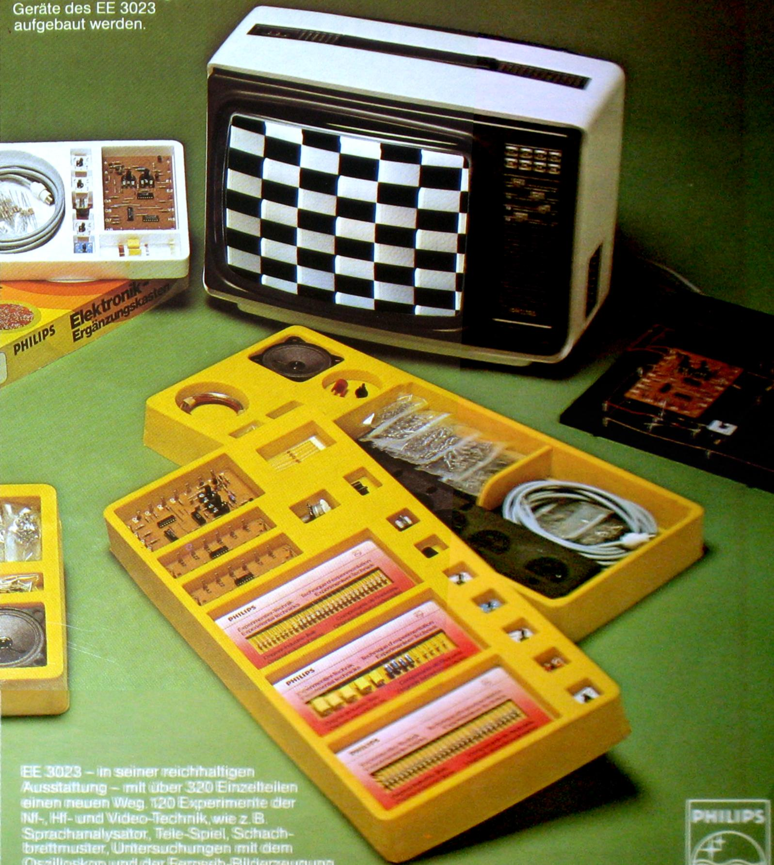
EE 3023 – in seiner reichhaltigen Ausstattung – mit über 320 Einzelteilen einen neuen Weg. 120 Experimente der NF-, HF- und Video-Technik, wie z. B. Sprachanalysator, Teile-Spiel, Schachbrettmuster, Untersuchungen mit dem Oszilloskop und der Fernseh-Bilderzeugung können durchgeführt werden.
