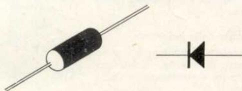
L'anello è chiaramente indicato negli schemi di montaggio. Installare, per finire, i transistori; sullo schema costruttivo sono riportate le lettere c, b, e (cioè collettore, base, emettitore). Sul transistor AC 126 è disposto un contrassegno colorato; il filo più vicino a tale contrassegno corrisponde al collettore.
