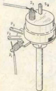
le su ogni terminale. Premerla e infilare il filo nel foro del terminale; rilasciare quindi la molla, che provvederà a bloccare il filo nel foro. I collegamenti al condensatore variabile ed al commutatore verranno effettuati con lo stesso sistema.
