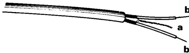
\*) Willst du einen Plattenspieler oder ein Tonbandgerät anschließen, beachte folgendes: Sie haben abgeschirmte Kabel (s. Skizze). Verbinde die Abschirmung (a) mit der Klemme, die mit dem Schaltpotentiometer verbunden ist, und die eine oder eventuell zwei Litzen (b) mit der anderen Anschlußfeder, die zu dem Polyester-Kondensator  $0,1 \mu\text{F}$  führt.
